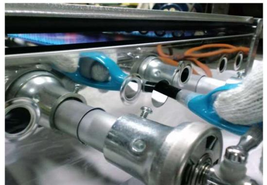
【手順5】火の走りが悪い場合は、レギュレーターを回して空気量を調整してください。締めていただくと火は走りやすくなります。
