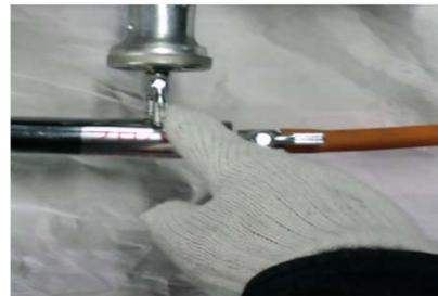
【手順4】点火窓に多目的ライター、別売りの点火棒を挿入して点火してください。
